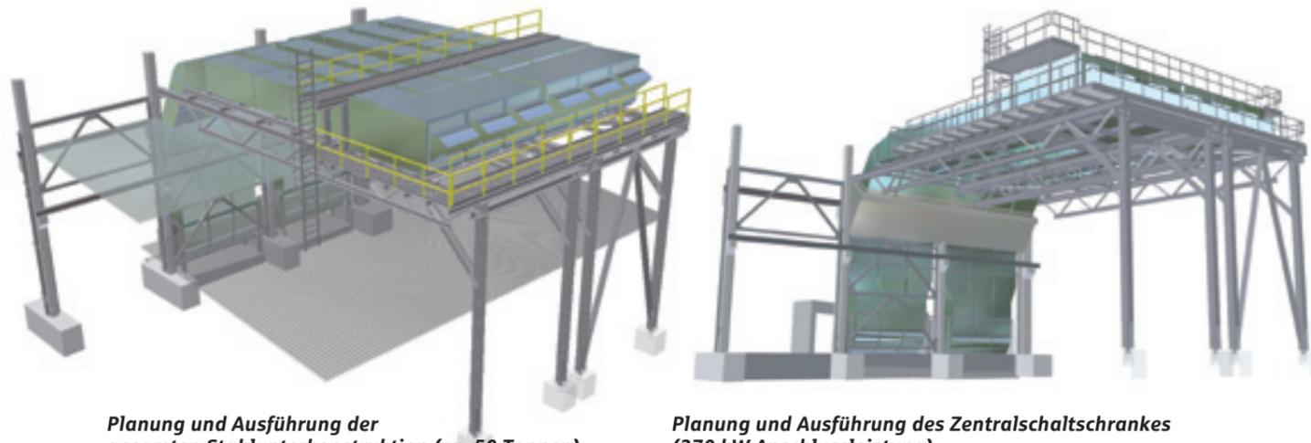
Planung und Ausführung der gesamten Stahlunterkonstruktion (ca. 50 Tonnen). Inkl. Wartungsbühnen auf zwei Ebenen
